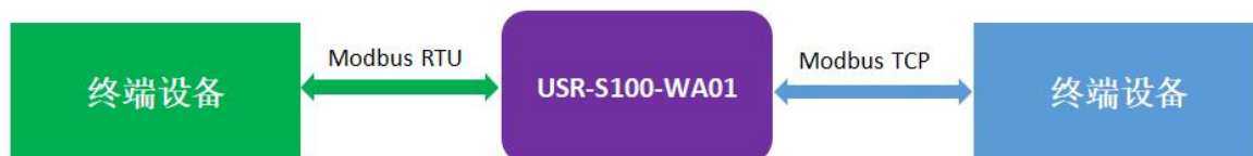
图 6 Modbus RTU & Modbus TCP 互转
